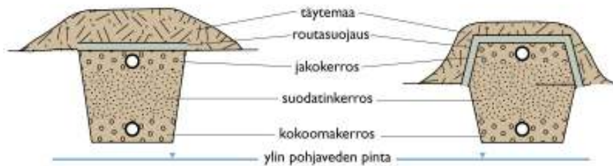
Maasuodattamon poikkileikkaus
